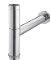
Артикул Описание 8.9424.9.000.000.1 сифон, хромированный ABS, регулируемая высота от 175 до 270 мм, высота до донного клапана 75 мм, поток воды до 45 л, с декоративными кольцами (может использоваться без колец)
